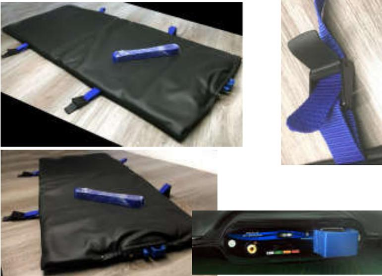
Neben der besseren Fixierung mit Gurten sind auch hier technische Verbesserungen eingebaut. Stärkere Spulen und die bewährte Modultechnik garantieren ein gutes und effektives Feld auch bei großen Tieren. Die Matte arbeitet mit einem Batterieeinschub für 9 Volt Blockbatterien. Natürlich kann auch ein Akku eingesetzt werden, der in einem separaten Ladegerät wieder aufgeladen werden kann. Für den Dauereinsatz ist auch hier ein Netzteil-Adapter einsetzbar.
